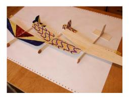
Zum Bemalen eignen sich hervorragend Faserschreiber, z.B. Textmarker oder dicke Faserstifte, keinesfalls Wasserfarben oder Lackfarben verwenden (Verzugsgefahr).
