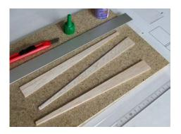
Auf <u>ein</u> Teil Sekundenkleber dünn auftragen, zweites Teil exakt auflegen und zusammenkleben (**nicht in den Kleber fassen!**), flach zum Trocknen liegen lassen (Verzugsgefahr!).
