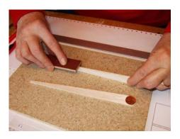
Rumpf oben und unten glatt schleifen (Klebeflächen für Tragflächen und Leitwerke).
