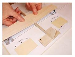
Auf der Rumpfoberkante im Auflagebereich der Tragflächenauflage Sekundenkleber dünn auftragen.
