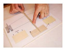
Im Klebebereich auf dem Höhenleitwerk in der Mitte Sekundenkleber dünn auftragen, Rumpf aufkleben (Tragflächenmarkierung oben!) und neben der Münze mit Stecknadeln fixieren.
