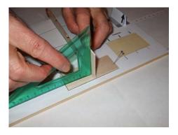
Auf den Rumpf im Klebebereich des Seitenleitwerks Sekundenkleber dünn auftragen, das Seitenleitwerk senkrecht aufkleben (schmale Kante oben!) und mit dem Zeichendreieck überprüfen.
