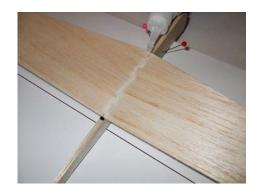
Auf die Stoßkante in der Tragflächenmitte dünn Sekundenkleber auftragen, mit Aktivator einsprühen und trocknen lassen.
