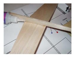
Alle Stecknadeln am Modell entfernen, das Modell auf den Rücken legen und in die Kante zwischen Tragfläche und Rumpf auf beiden Seiten, vorn und hinten, noch einen Tropfen Sekundenkleber auftragen.
