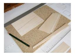
Tragflächenteile nach Plan abmessen und zuschneiden.
