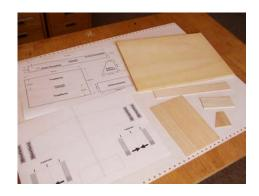
Bauplan Plan Bauschablone Baubrett Holzteile: für Rumpf, Tragflächen, Höhenleitwerk und Seitenleitwerk
