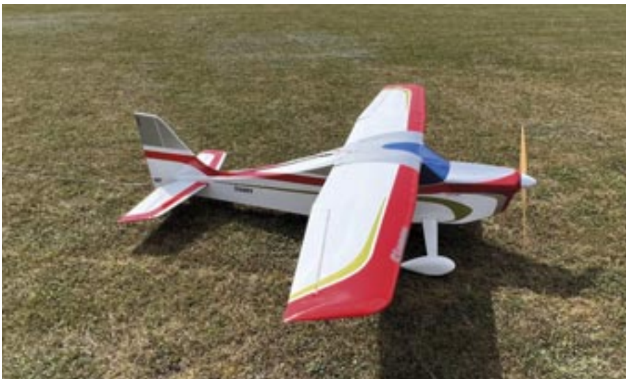
Elektroschlepper Eigenbau mit 12S Antrieb.
