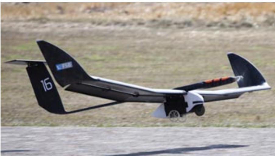
Die Gewinnerkonstruktion der Euroavia Zagreb von 2015: Ein hoher Auftrieb bei niedriger Geschwindigkeit ist notwendig, um die Nutzlast innerhalb der kurzen Startstrecke in die Luft zu heben.
