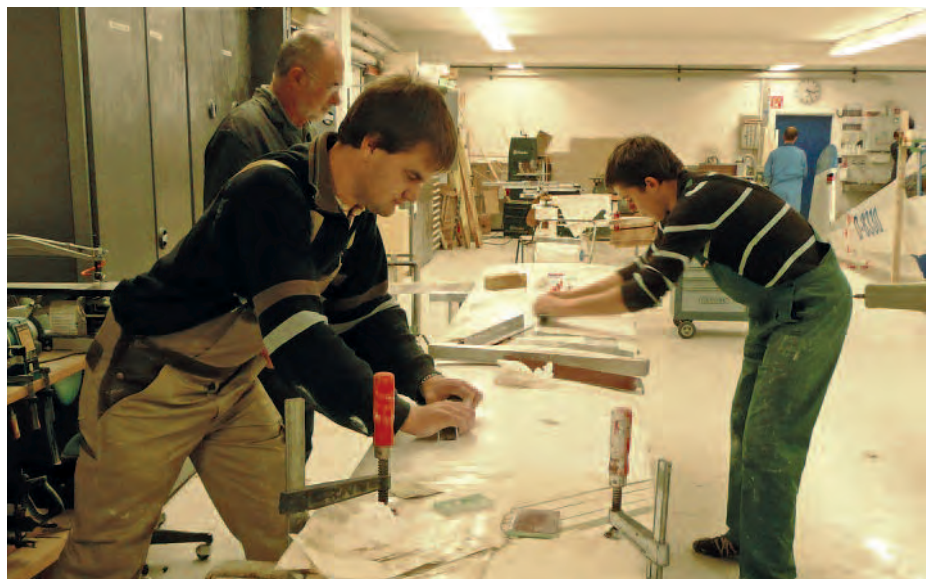
Schleifen der laminierten Flächen.
