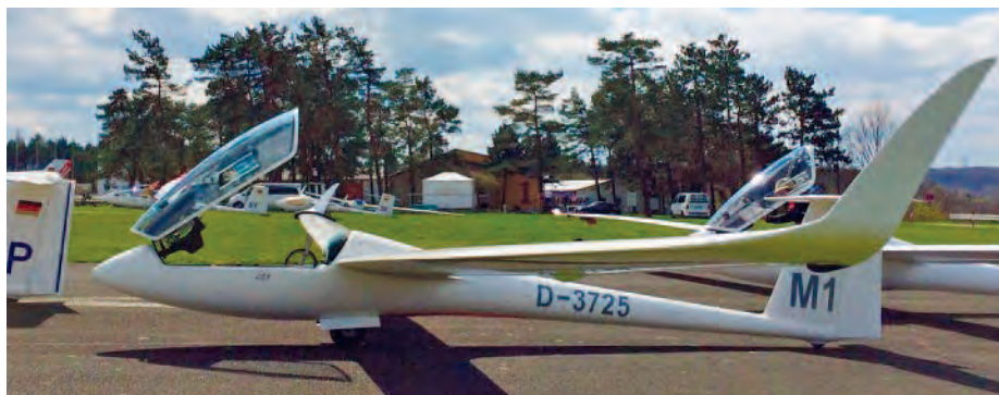
Das LVB-Förderflugzeug M1 mit den neuen Winglets.
