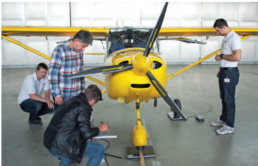
Ein Ultraleichtflugzeug beim Wiegevorgang.
