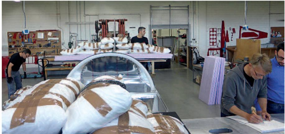
Prüfungsarbeiten zur Änderung des Modells "Breezer".
