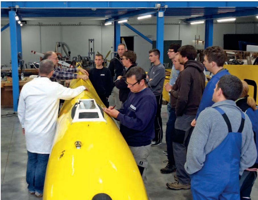
Am umgedrehten Rumpf einer ASK13 erfolgte zunächst die Befundung, danach die Arbeitsverteilung.
