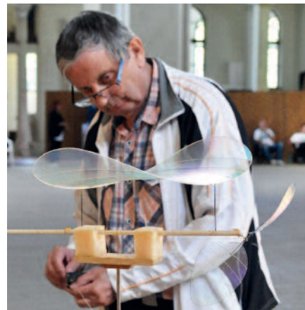
Vize-Europameister Lutz Schramm bei der Startvorbereitung. Der Gummi wird außerhalb des Modells aufgezogen, damit es bei einem Strangriss nicht beschädigt wird.
