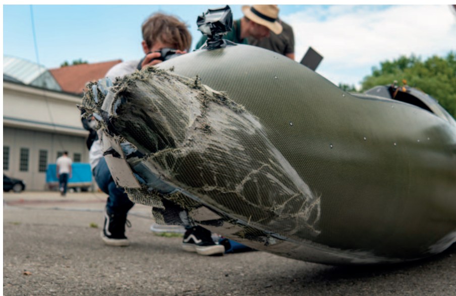
Detailaufnahme der Nase der Mü32 nach dem Crash.
