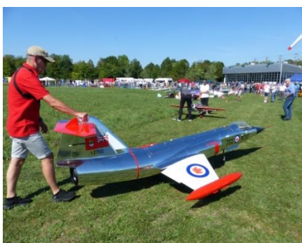
Bild 7: Der Starfighter F104 von Harald Jezek nach einem gelungenen Flug. Das Modell wurde in Eigenbau komplett in Holzbauweise erstellt und mit Chromfolie bespannt. Bei einem Schub/Gewichts Verhältnis von fast 1:1 zeigte das Modell
